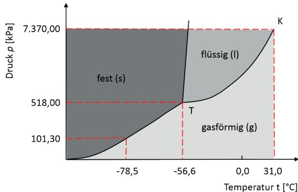
Die Abbildung zeigt das Phasendiagramm von CO<sub>2</sub>.
